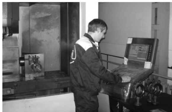
Механическая обработка корпусов дисковых поворотных затворов
